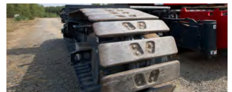
Flachbodenplatten • Flat crawler pads • Tuiles plates • Pattini lisci Tejas planas • Плоские гусеничные траки
