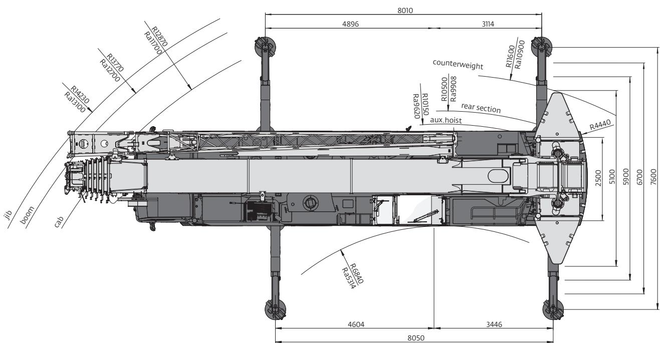
*Ra = Radius all wheels steered. • Radius altradgelenkt. • Rayon toutes les roues directrices. • Radio de giro con todas las ruedas giradas. • Raggio di curva con tutte le ruote sterzate.*
